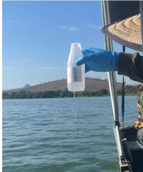
**Figura 06.** Frasco furado para análise de sulfeto.
