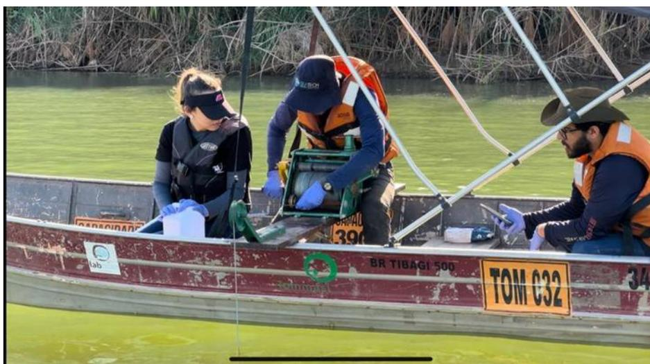
**Figura 09.** Execução da medida de descarga sólida pelos colaboradores no primeiro ponto na RDO 12.
